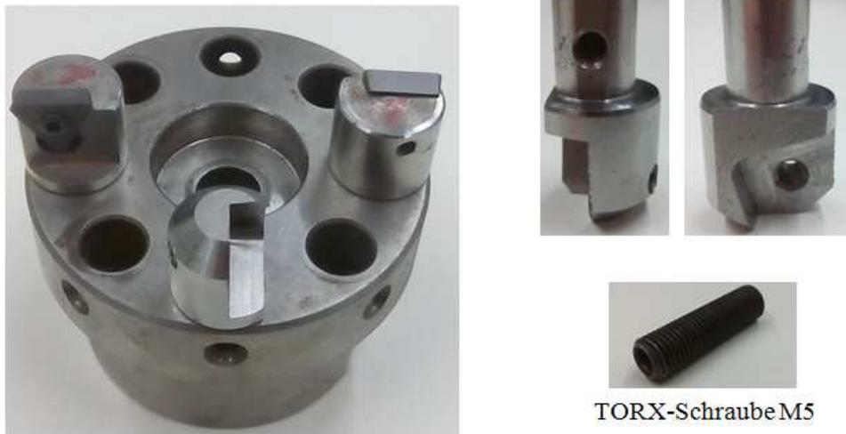
Abbildung 1. Kassettensystem-Fräswerkzeug (D=80 mm) und Rundschafft für die Spannung mit einer TORX-Schraube; Quelle: IFQ
